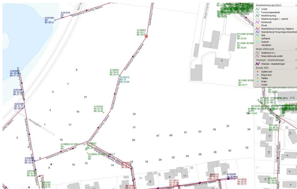
Figur 6: Nord-Syd gående spildevandskloak der gennemskærer området. Ledningen benyttes til udledning til kloak.
